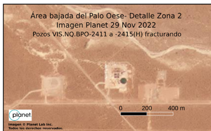
Figura 5. Área Bajada del Palo Oeste. Pozos VIS.NQ.BPO-241x (H) fracturando en Noviembre de 2022. Sus ramas horizontales se extienden entre los 2300 y 3200 m de longitud, a una profundidad de unos 3250 m. Realizaron, simultáneamente, unas 50 fracturas de promedio e inyectaron un total de unos 90 mil m 3 de materiales (fluidos y arenas) por pozo en menos de un mes (350 mil m 3 en conjunto). Al menos dos sismos, de 2,7 y 2.9 ML, tuvieron lugar a menos de 5 km de los pozos durante el periodo de fractura. Se trató de los últimos pozos en ser fracturados en el área de explotación y los últimos sismos en ocurrir.
